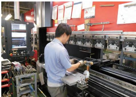
精密板金加工の曲げ作業中
