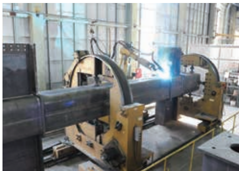
鉄骨の柱をロボットにて溶接中
