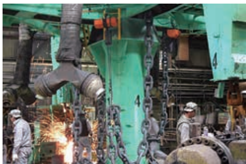
大型チェーンの製造風景 左奥で火花を上げているのがフラッシュパット溶接機です
