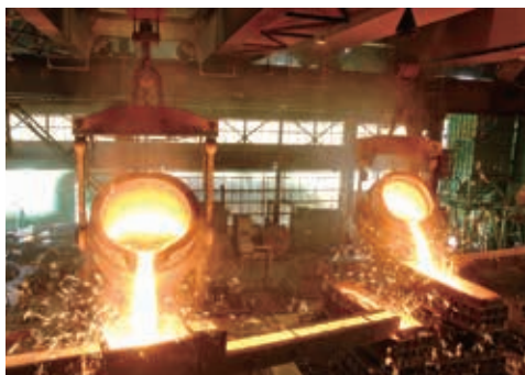
溶けた鉄を型に流し込む「鑄込み作業」 その迫りに圧倒されます
