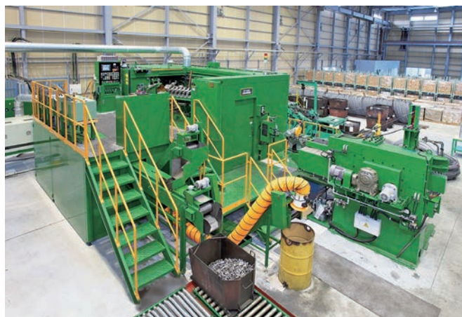
大型生産設備（冷間圧造フォーマー）
