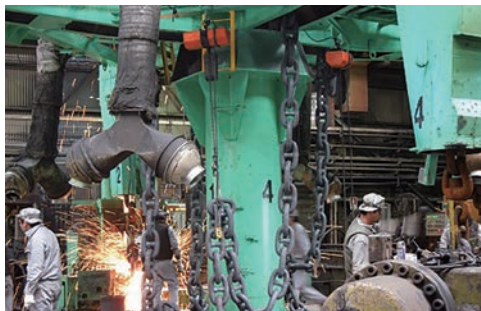
大型チェーンの製造風景 左奥で火花を上げているのがフラッシュバット溶接機です
