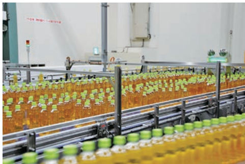
能力アップのラインが稼働し、1分間で900本製造しています
