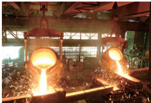
溶けた鉄を型に流し込む「鑄込み作業」その迫力に圧倒されます
