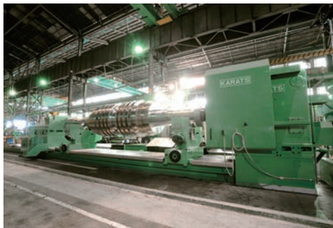
当社播磨工場の超大型精密NC旋盤
