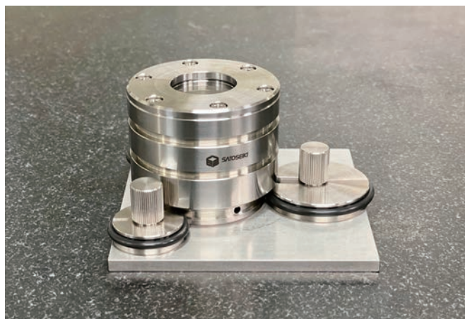
大気遮断型試料輸送容器 「はやぶさ2」プロジェクト使用
