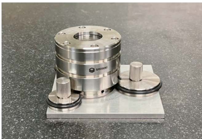
大気遮断型試料輸送容器 「はやぶさ2」プロジェクト使用
