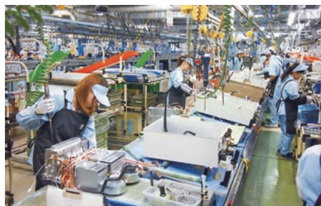
給湯器の生産ライン
