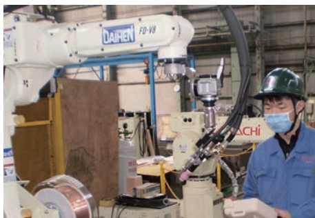
ロボットティーチング作業の様子
