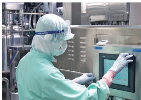
ミキサーをタッチパネルで操作し、化粧品を製造しています
